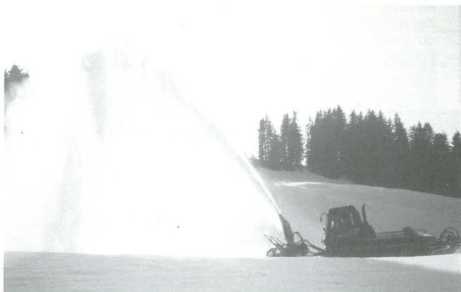
Démonstration d'enneigement par Maurice RAMEL avec la nouvelle Kassbohrer 240 CV équipée de la turbo fraise.
