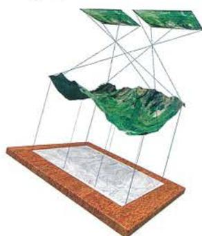
**Un plan photogrammétrique est un plan obtenu à partir de l'exploitation de photos aériennes, grâce au principe de la vue en stéréoscopie (la superposition de clichés décalés permet de voir en 3 dimensions).**
