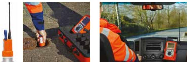
Ce système est constitué de 10 écouteurs qui peuvent être placés sur nos canalisations par secteur pour enregistrer les bruits continus dans la nuit en fréquence et en niveau sonore (hertz & décibel). Les informations récoltées sont analysées le matin suivant. Celles-ci nous permettent de cibler plus précisément nos recherches. Le service a également investi dans un compteur débitmètre portable afin de contrôler l'efficacité et le bon fonctionnement de l'ensemble de nos 130 poteaux incendie. ■
